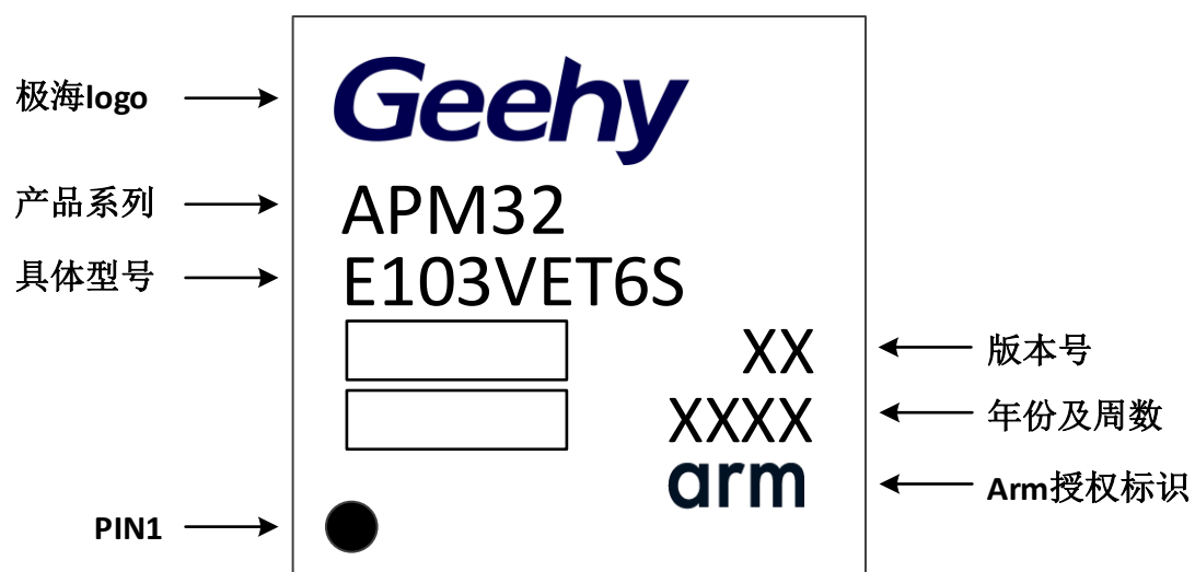
图 15 LQFP100 - 100 引脚, 14 x 14mm 封装标识
