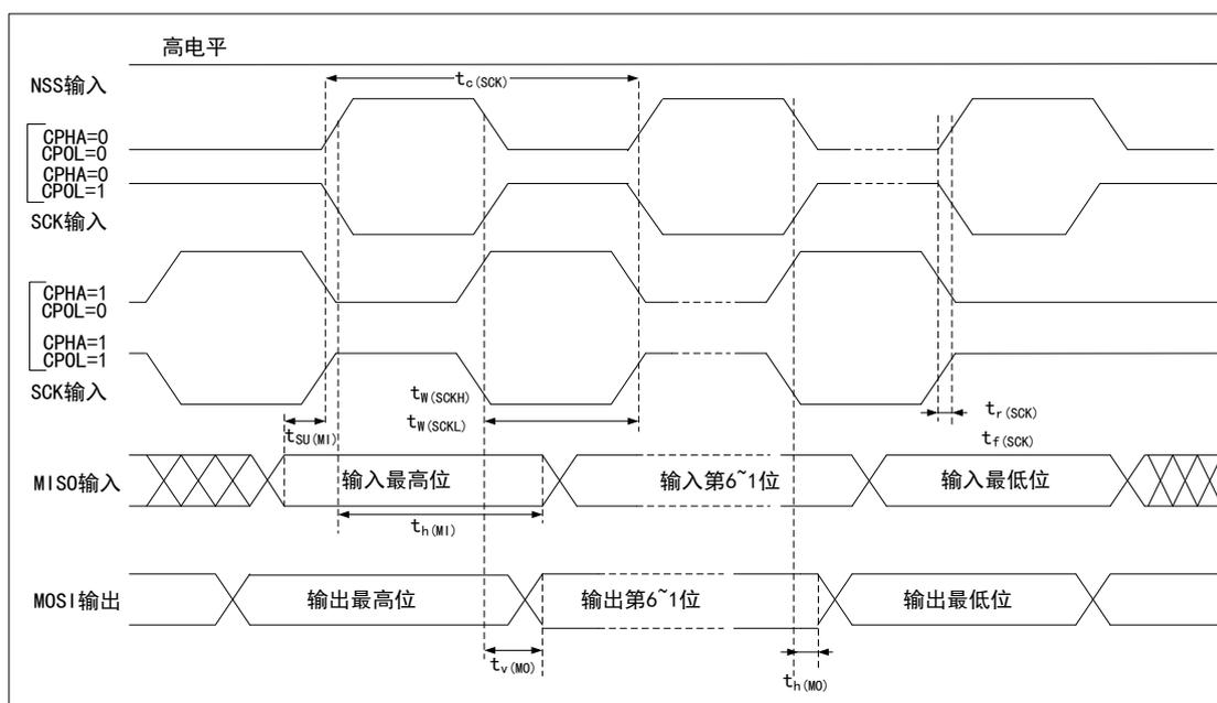
注：测量点设置于 CMOS 电平：0.3V<sub>DD</sub> 和 0.7V<sub>DD</sub>。
