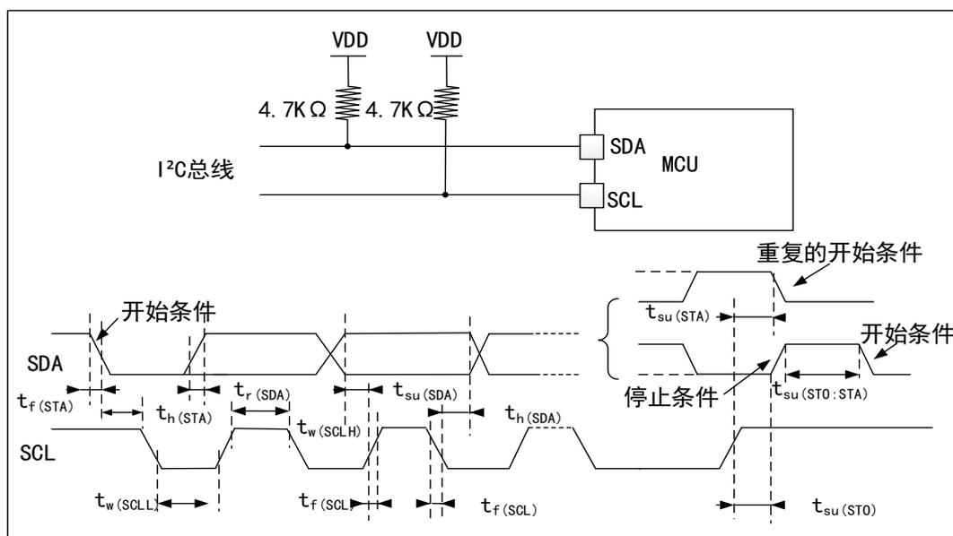
注：测量点设置于 CMOS 电平： $0.3V_{DD}$  和  $0.7V_{DD}$ 。
