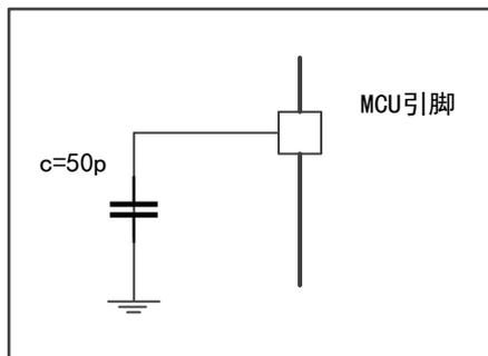
图 6 引脚输入电压测量方案
