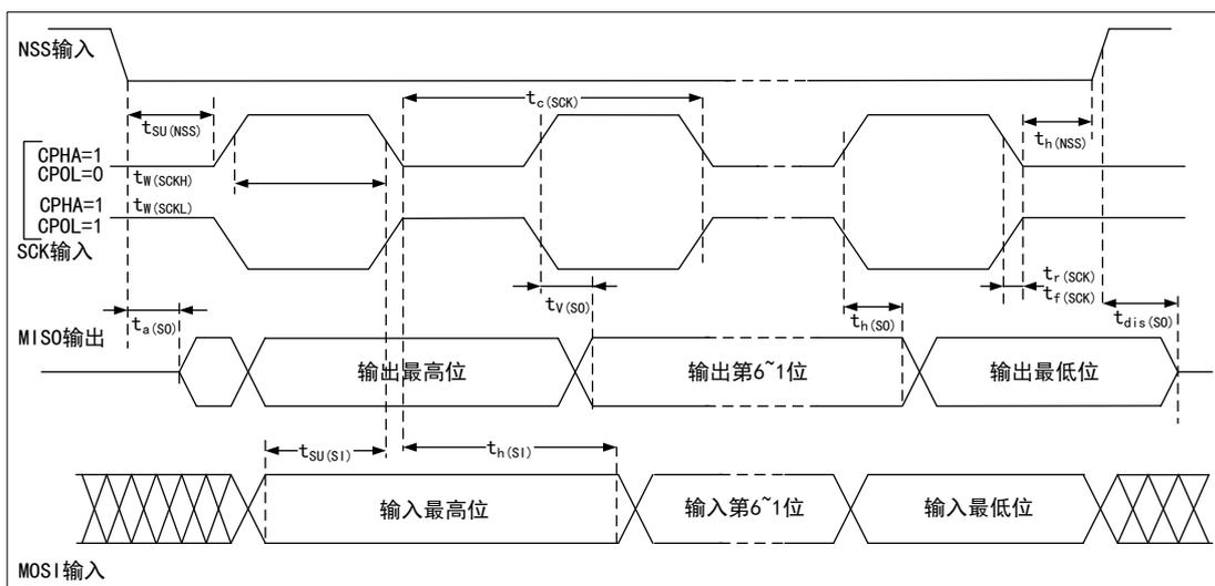
注：测量点设置于 CMOS 电平：0.3V<sub>DD</sub> 和 0.7V<sub>DD</sub>。
