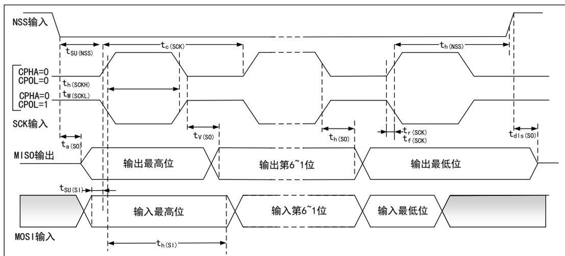
图 11 SPI 时序图—从模式和 CPHA=1
