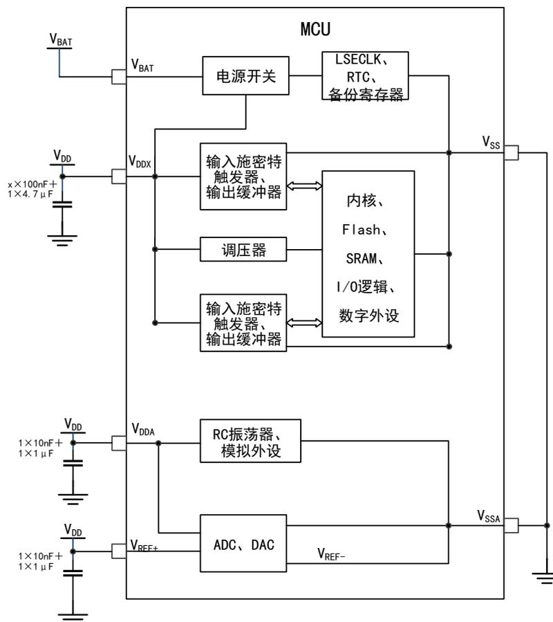
说明：图中的  $V_{DDx}$  表示  $V_{DD}$  的个数是  $x$  个
