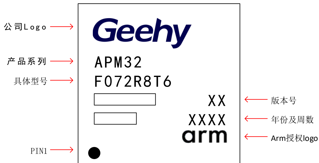
图 21 LQFP64 - 64 引脚，10 x 10mm 封装标识
