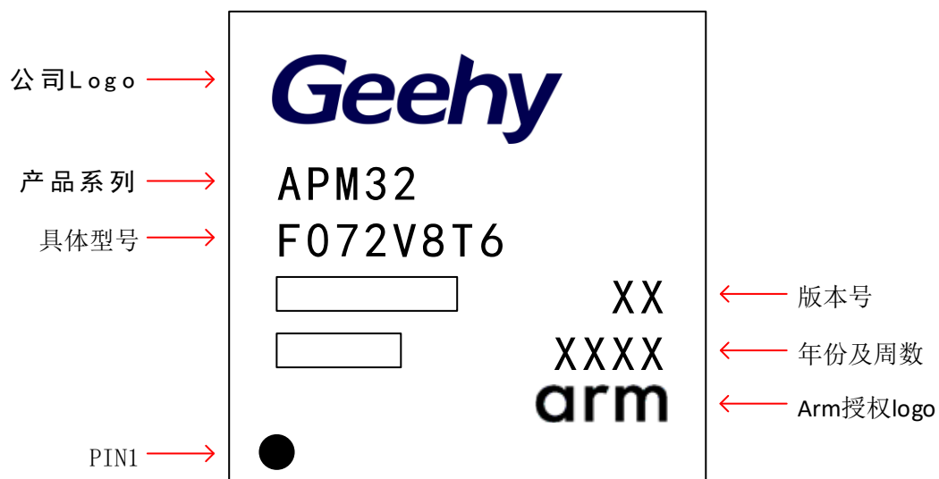
图 18 LQFP100 - 100 引脚, 14 x 14mm 封装标识
