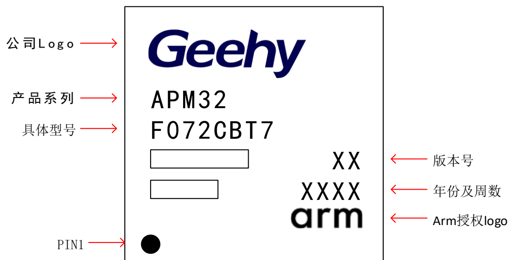
图 16 LQFP48-48 引脚，7×7mm 封装标识
