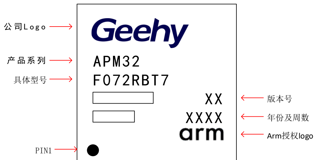
图 19 LQFP64 - 64 引脚，10 x 10mm 封装标识
