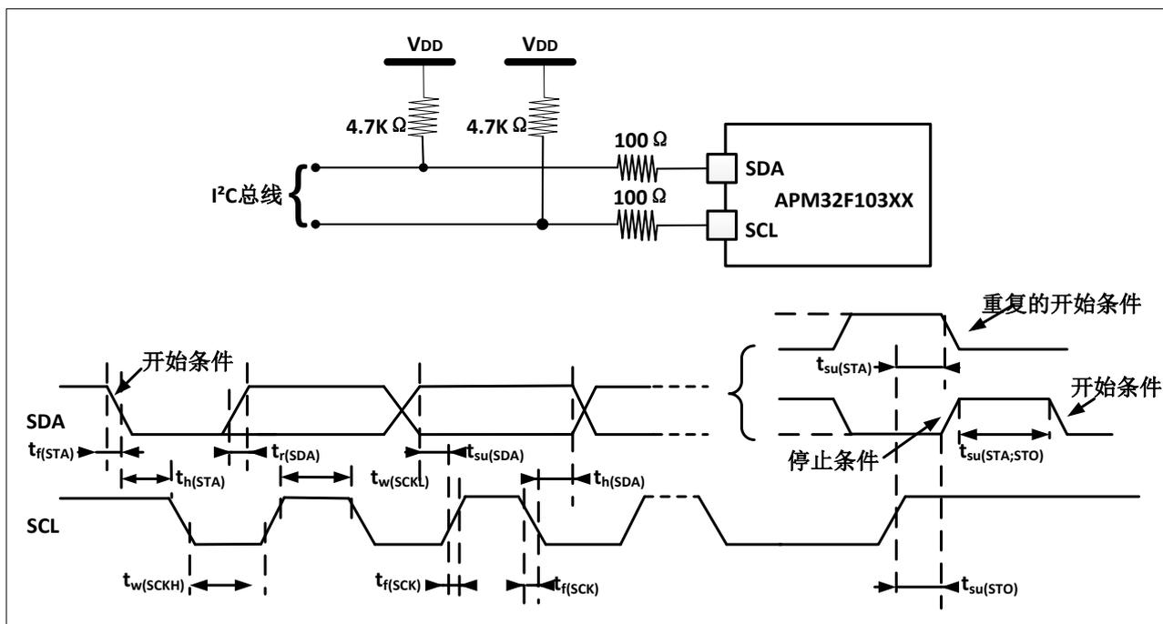
1. 测量点设置于 CMOS 电平：0.3V<sub>DD</sub> 和 0.7V<sub>DD</sub>。
