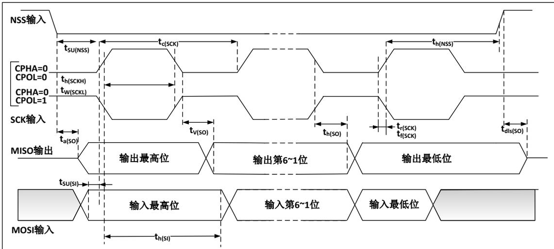
图17 SPI时序图 — 从模式和 CPHA=1<sup>(1)</sup>
