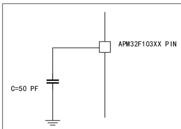
图10 引脚输入电压测量方案
