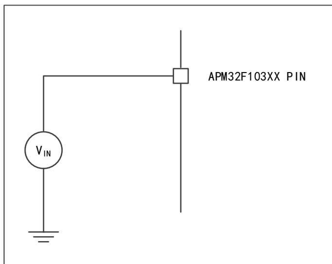
图11 电流消耗测量方案
