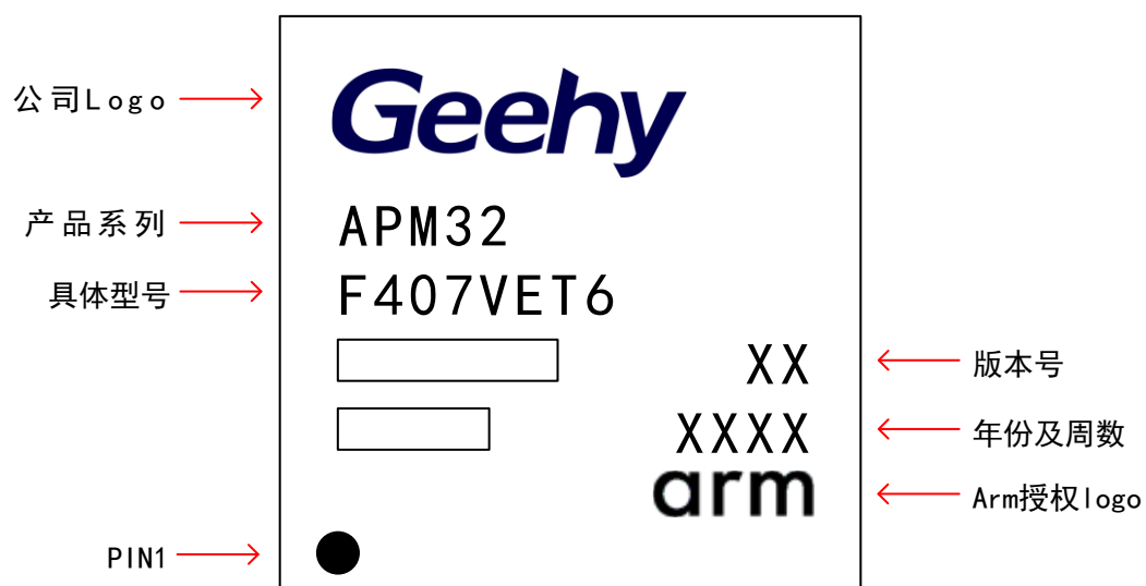
图 25 LQFP100 - 100 引脚，14 x 14mm 示意图
