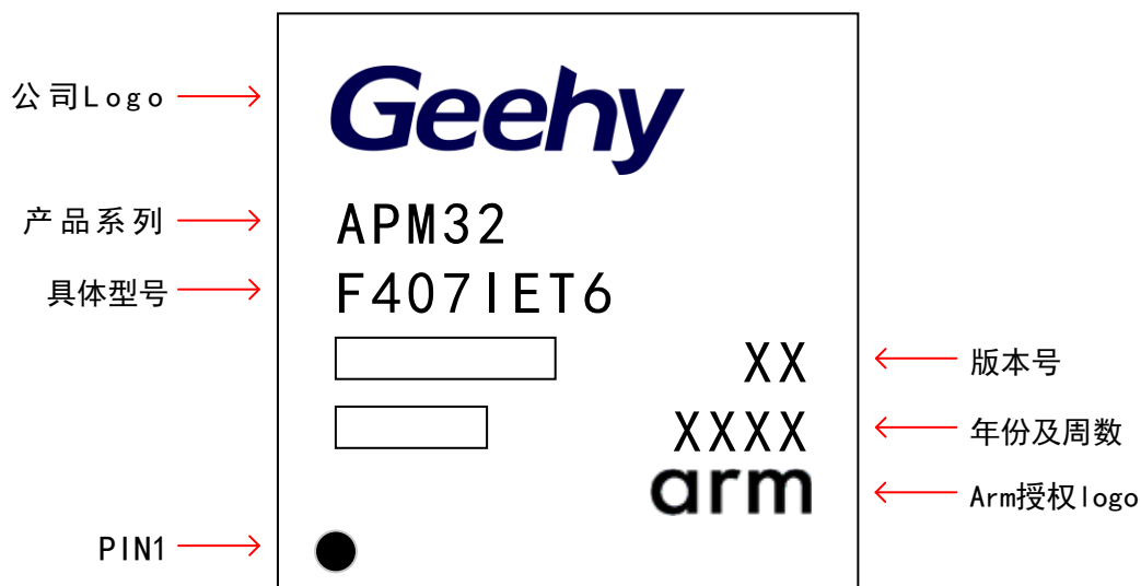
图 19 LQFP176 -176 引脚，24 x24 mm 示意图
