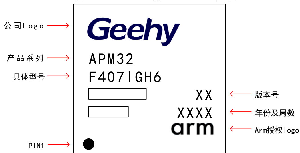
图 31 LQFP64 - 64 引脚，10 x 10mm 示意图
