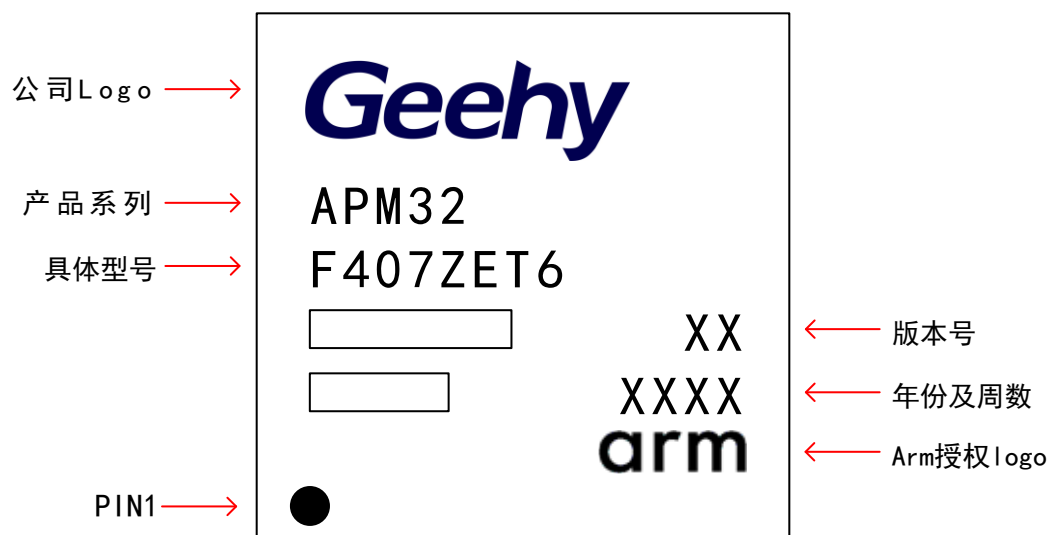
图 22 LQFP144 -144 引脚，20 x20mm 示意图
